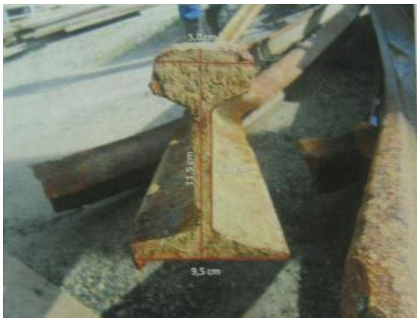
Figura 32: Formato e medidas de uma das partes do trilho pertencentes à Estrada Belém-Bragança. Fonte: Relatório de Acompanhamento 8/IPHAN (2013).
